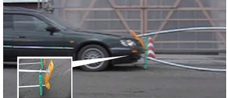
「突き抜け抑制」の安全検証 (時速 55km による車両衝突)
